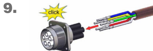
Kontakte (2) vollständig in Isolierkörper einführen, bis die Kontakte einrasten. 🗨 Durch leichtes Ziehen am Kabel den korrekten Kontaktsitz überprüfen.
