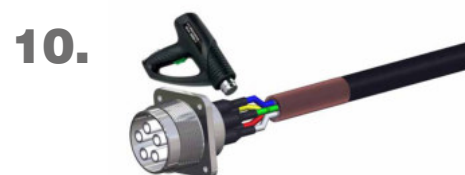
Schrumpfschlauch schrumpfen - Schrumpftemperatur 110°C
