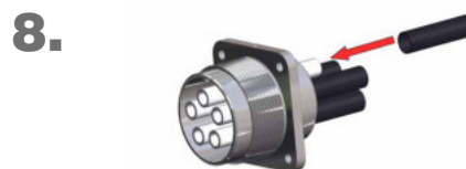
Schrumpfschlauch (1) von hinten auf Isolierkörper aufschieben.
