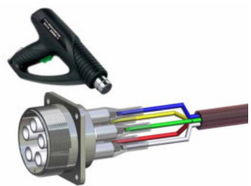
Schrumpfschlauch schrumpfen - Schrumpftemperatur 110°C.
